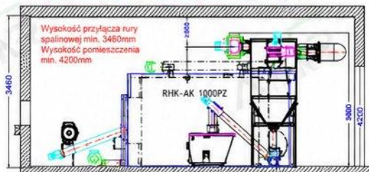
Multicyklon z popielnikiem do popiołu dennego 900 litrów
