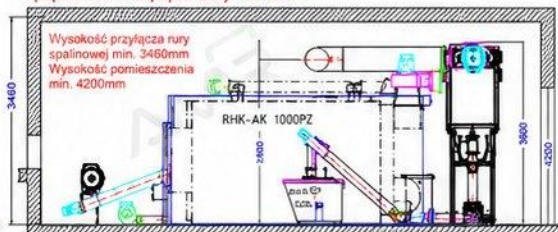
Multicyklon z oddzielnym popielnikiem do popiołu dennego 240 litrów i popielnikiem na popiół lotny 900 litrów
