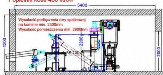
Multicyklon z popielnikiem oddzielnym wysypowym 240 litrów Popielnik kotła 400 litrów
