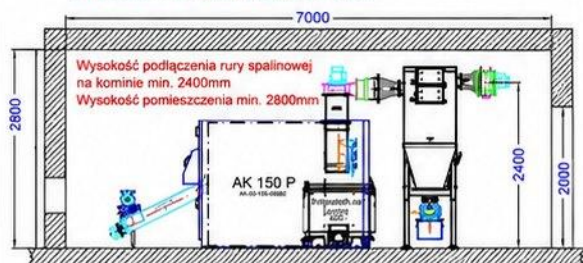
Multicyklon z popielnikiem 40 litrów Popielnik 400 litrów bezpośrednio
