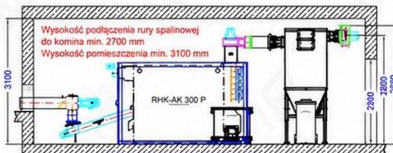
Multicyklon z popielnikiem 240 litrów Popielnik 400 litrów bezpośrednio
