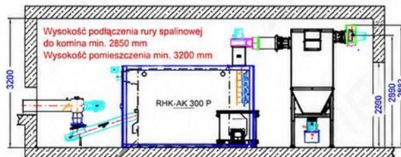
Multicyklon z popielnikiem 40 litrów Popielnik 400 litrów bezpośrednio
