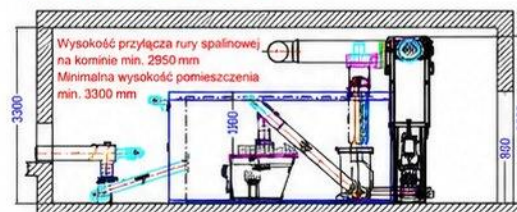
Multicylon z oddzielnym usuwaniem popiołu 240 litrów Pojemnik na popiół 900 litrów
